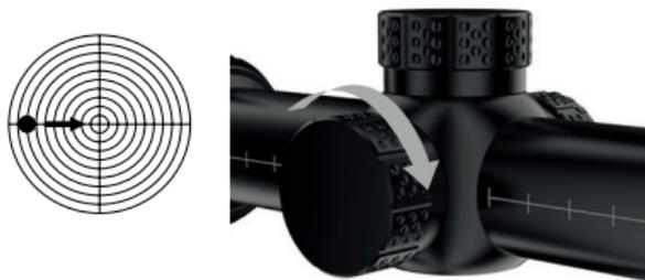
Nun schrauben Sie die Kappe des Seitenturms ab. Wenn die Trefferpunktabweichung wie im Bild oben 10 cm beträgt, drehen Sie den Seitenturm um 10 Klicks ( $1\text{ cm} \times 10\text{ Klicks} = 10\text{ cm}/100\text{m}$ ) in die entsprechende Richtung.
