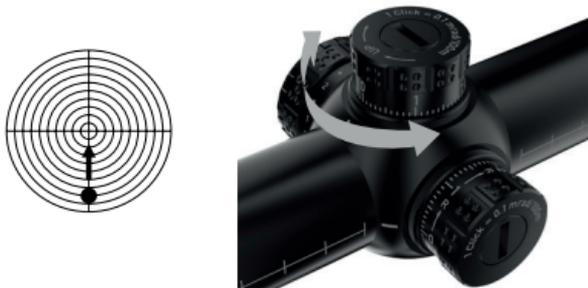
Nun schrauben Sie die Kappe des Höhenturms ab. Wenn die Trefferpunktabweichung wie im Bild oben 10 cm beträgt, drehen Sie den Höhenturm um 10 Klicks ( $1\text{cm} \times 10 \text{ Klicks} = 10 \text{ cm}/100\text{m}$ ) in die entsprechende Richtung.
