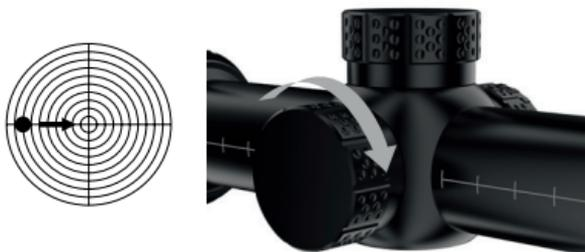
Ora svitate il coperchio della torretta laterale. Se lo scostamento del punto di impatto sul bersaglio è di 10 cm come indicato nella in alto, ruotate la torretta laterale di 10 clic ( $1 \text{ cm} \times 10 \text{ clic} = 10 \text{ cm}/100\text{m}$ ) nella direzione corrispondente.
