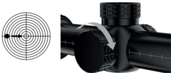
Nå skrur kappen på sidejusteringen av. Hvis treffpunktavviket er som på bildet ovenfor 10 cm, dreies sidejusteringen med 10 klikk ( $1\text{ cm} \times 10\text{ klikk} = 10\text{ cm}/100\text{m}$ ) i samsvarende retning.
