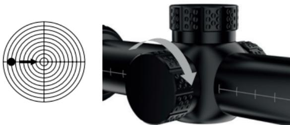
Skruva nu av locket av sidoteleskopet. När träffpunktsavvikelsen är 7 cm som på bilden ovan, vrid teleskopet med 10 klick (1 cm x 10 klick = 10 cm / 100m) i motsvarande riktning.
