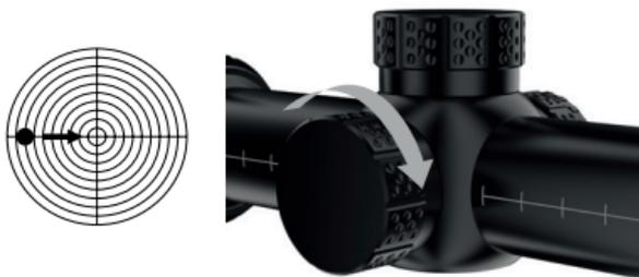
A continuación, desenrosque la tapa de la torreta de regulación lateral. Cuando la desviación del punto de impacto sea de 10 cm como en la imagen anterior, gire la torreta de regulación lateral 10 clics ( $1\text{cm} \times 10 \text{ clics} = 10\text{cm}/100\text{m}$ ) en la dirección correspondiente.
