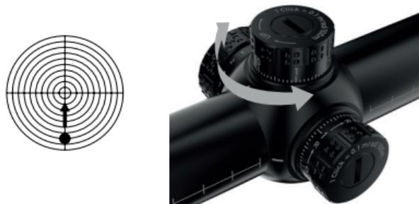
Nu skruer du kappen på højdetårnet af. Når træfpunktsafvigelsen, som på billedet ovenfor, er 10 cm, skal du dreje højdetårnet 10 klik (1 cm x 10 klik = 10 cm/100 m), i tilsvarende retning.
