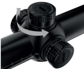
Skruva nu av locket av teleskopet. När träffpunktsavvikelsen är 10 cm som på bilden ovan, vrid teleskopet med 10 klick (1 cm x 10 klick = 10 cm / 100m) i motsvarande riktning.
