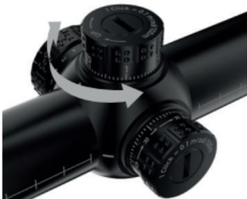
Nå skrur kappen på høydejusteringen av. Hvis treffpunktavviket er som på bildet ovenfor 10 cm, dreies høydejusteringen med 10 klikk (1 cm x 10 klikk = 10 cm/100m) i samsvarende retning.
