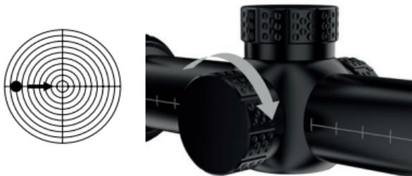
Nu skruer du kappen på sidetårnet af. Når træfpunktafgivelsen, som på billedet ovenfor, er 10 cm, skal du dreje sidetårnet 10 klik (1 cm x 10 klik = 10 cm/100 m), i tilsvarende retning.
