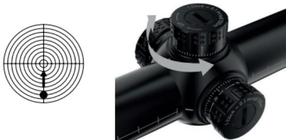
Ora svitate il coperchio della torretta superiore. Se lo scostamento del punto di impatto sul bersaglio è di 7 cm come indicato nella Fig. 7 in alto, ruotate la torretta superiore di 10 clic ( $0,7\text{cm} \times 10 \text{ clic} = 7 \text{ cm}/100\text{m}$ ) nella direzione corrispondente.
